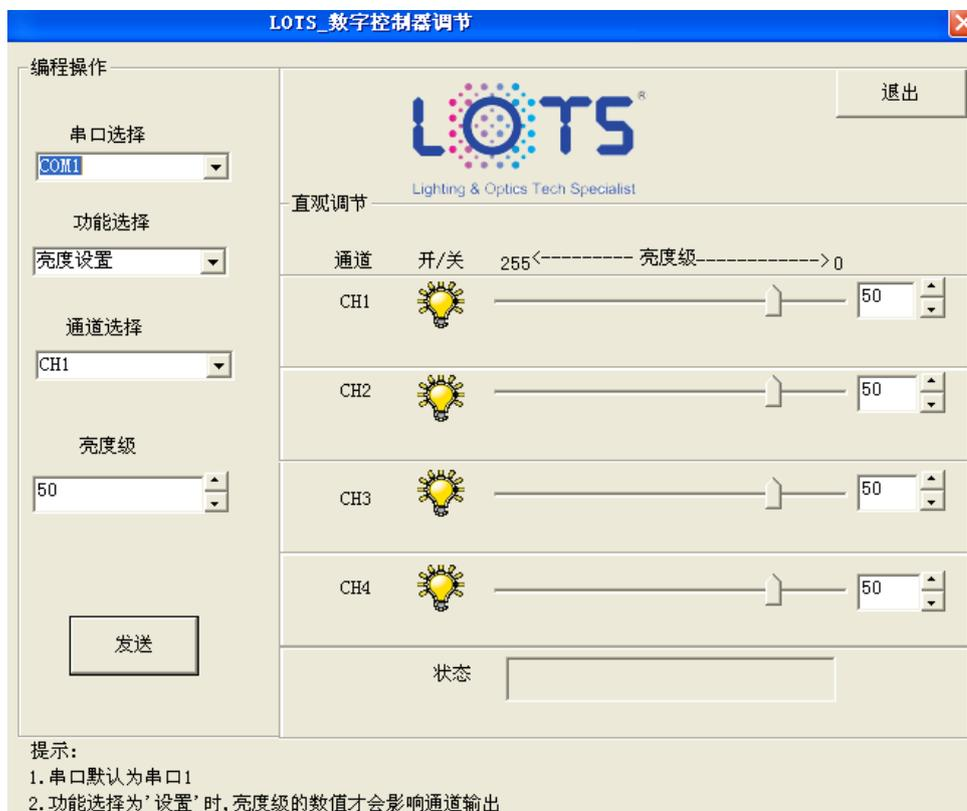
串口选择：选择控制器所连接的通信串口。
